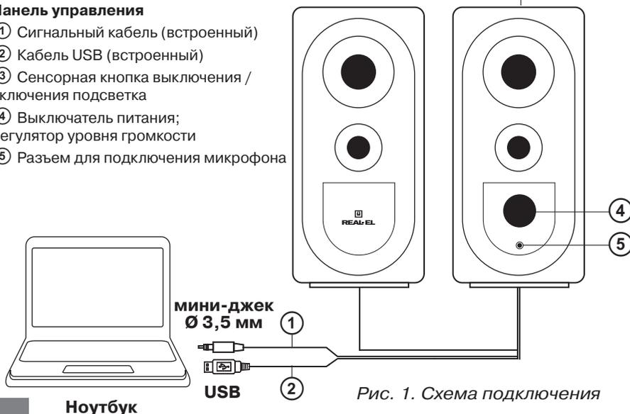
Рис. 1. Схема подключения
